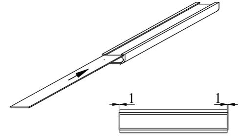
Кромку вставить со свесом 1мм, лишнее отрезать
