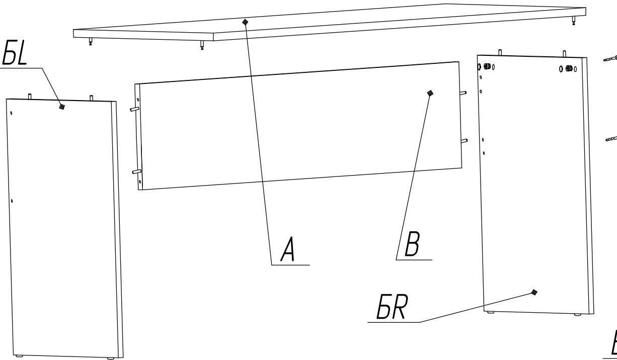
4. Собрать стенку заднюю поз. В со стенками боковыми поз. Б и стянуть их винтами поз. 5. На винты установить заглушки поз. 6.
