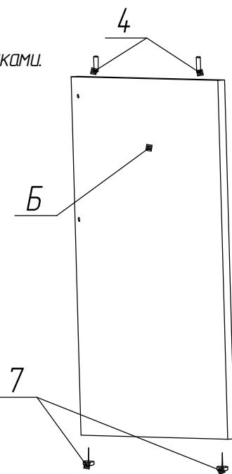
3. В крышку поз. А в отверстия диаметром 5 мм, вкрутить винты эксцентриковые поз. 2.
