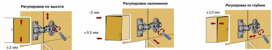
Рис.3 Схема установки петель
