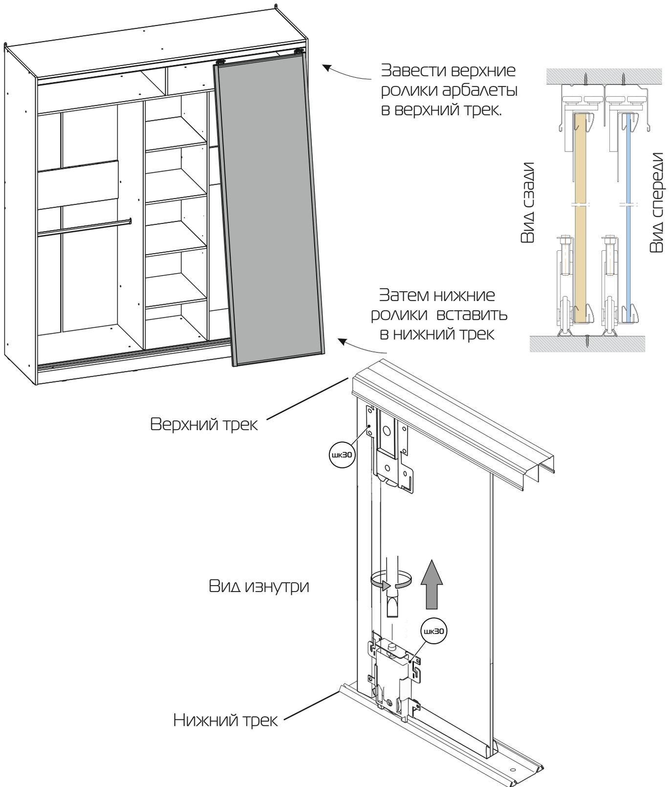
Завести верхние ролики двери в верхнюю направляющую шкафа купе, а нижние ролики в пазы нижней направляющей.
