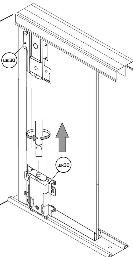
Завести верхние ролики двери в верхнюю направляющую шкафа купе, а нижние ролики в пазы нижней направляющей.
