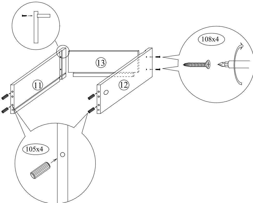
⑬ Установка дна в корпус ящика
