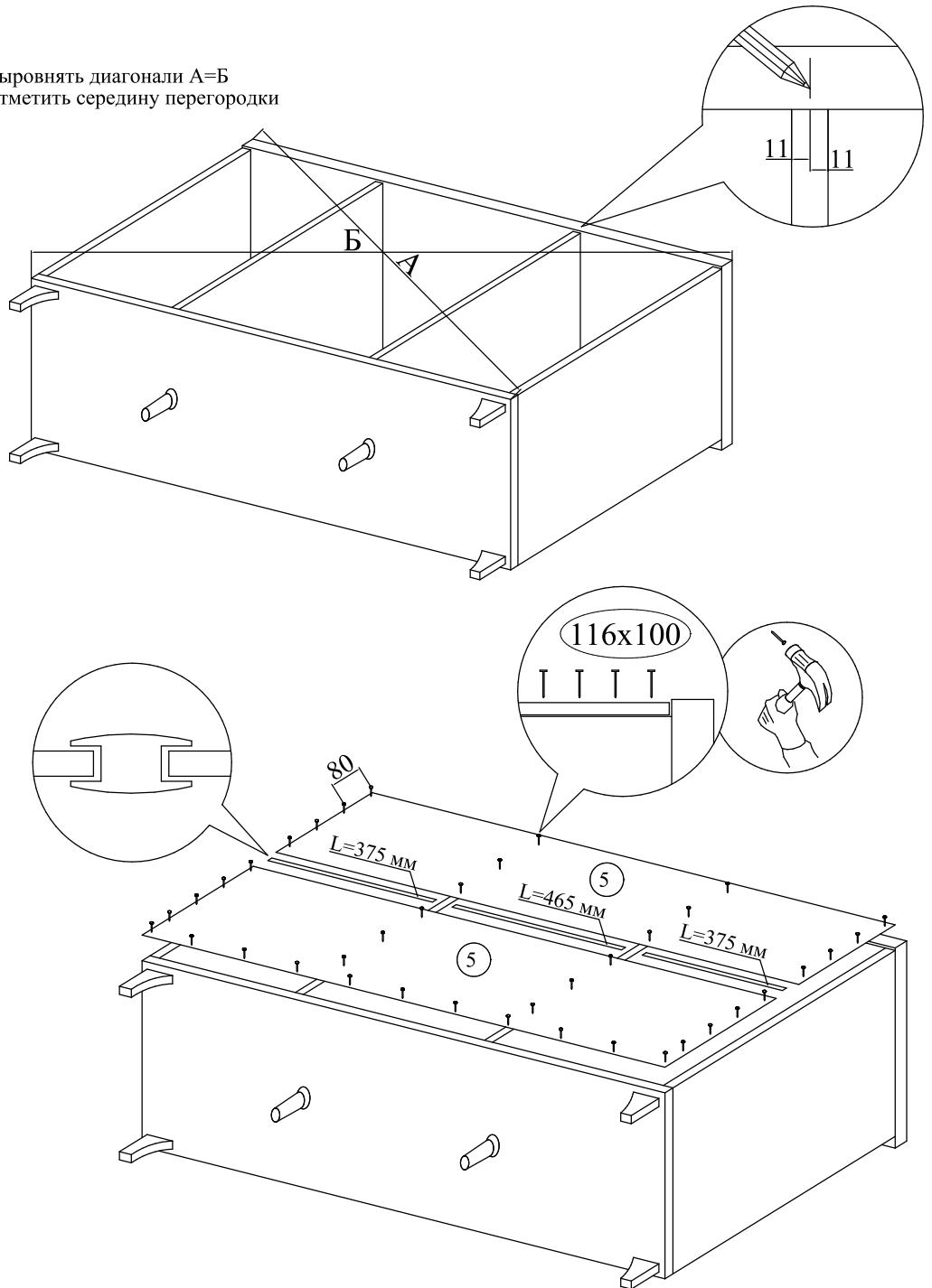
⑪ Крепление стенок задних к корпусу комода.
