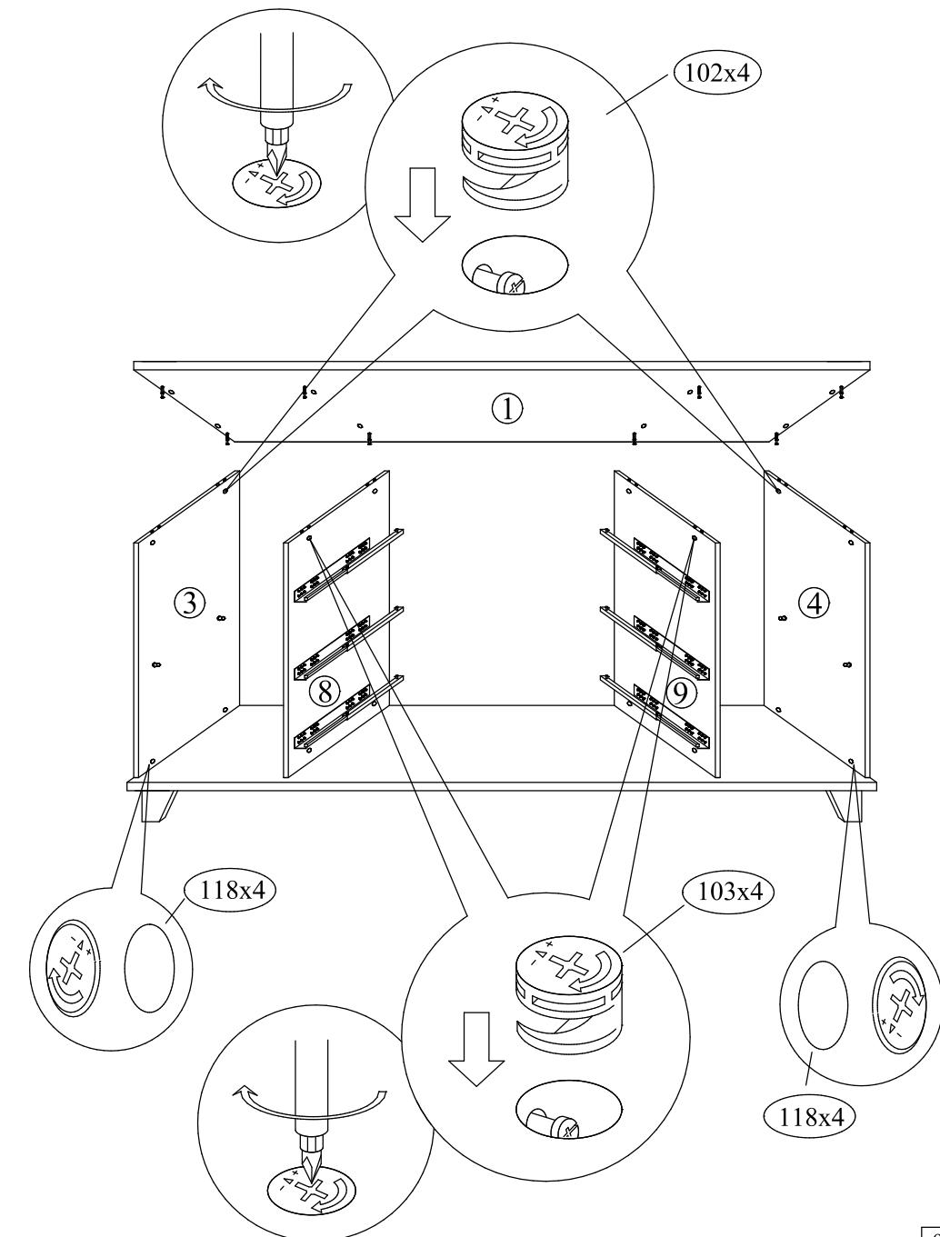
⑩ Крепление стенок задних к корпусу комода.
