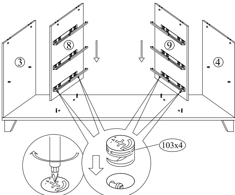
После установки и закрепления перегородок эксцентриками, необходимо закрепить нижнюю направляющую на передний евровинт.
