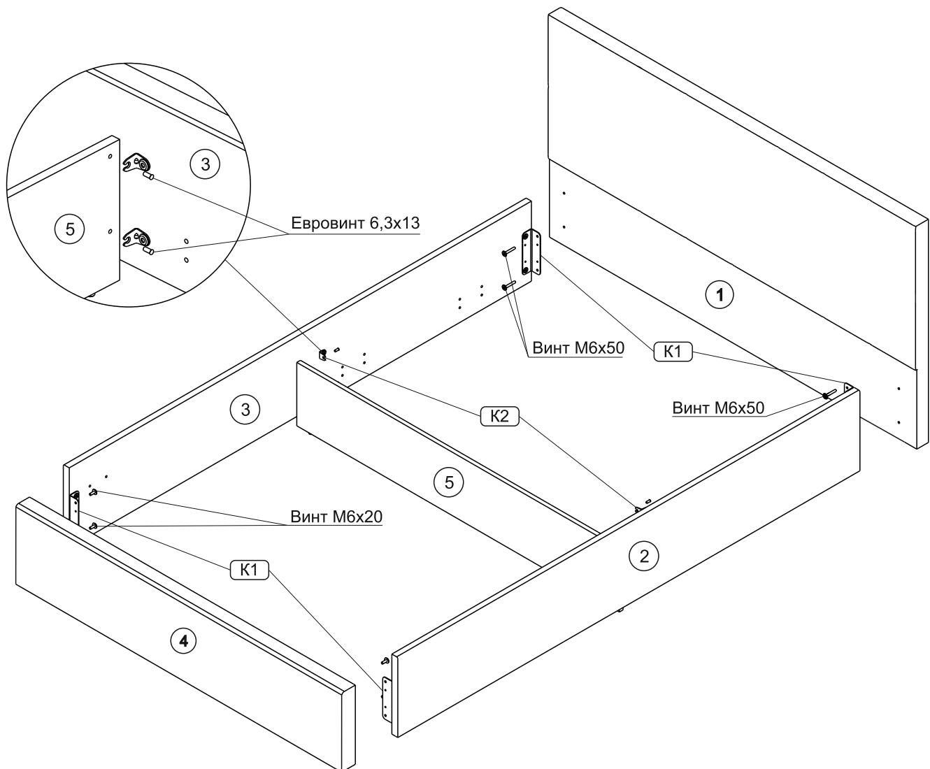
**Схема 3. Установка элементов подъемного основания ортопедического**
