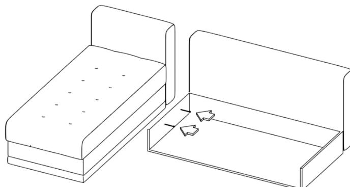
1. Устанавливаем на пол бельевой ящик со спинкой и соединяем его с оттоманкой на болты 2 шт.
