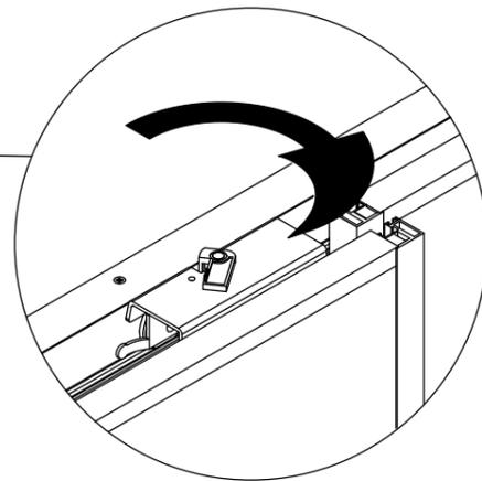
Закрытие стопорного фиксатора ОБЯЗАТЕЛЬНА!
