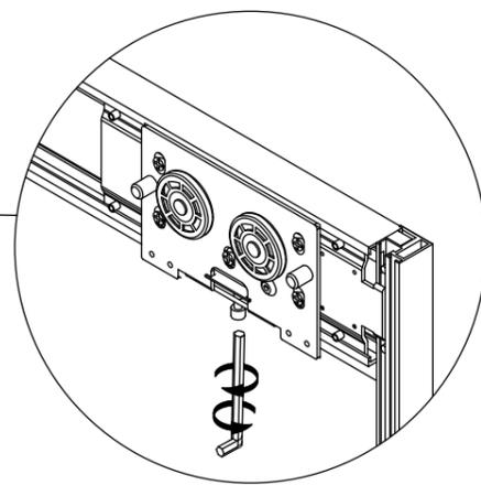
При необходимости выравнивания дверей, выполните их демонтаж с последующей регулировкой роликов
