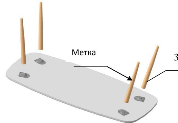
**3.** Установить полку поз. 2 и закрутить шурупами поз. В, совместив метки на ножках с отверстиями в полке.
