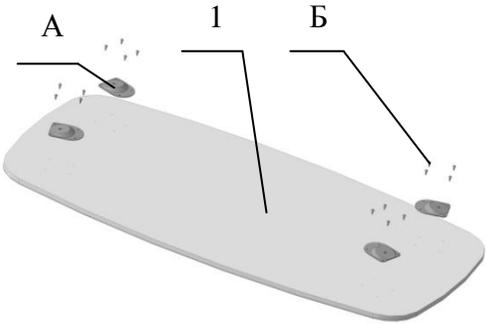
**2.** Вкрутить опоры поз.3., направив метки внутрь стола, для прикручивания полки.
