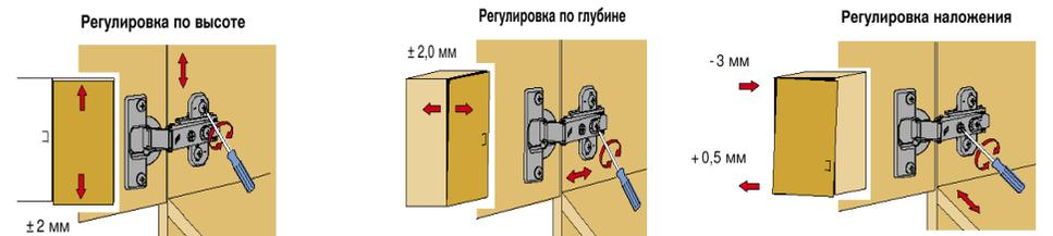
Слегка ослабить крепежные винты ответной планки, вывернуть по высоте позицию двери. Затем крепежные винты снова затянуть.
